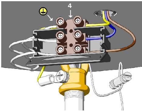
Agganciare la lampada al soffitto, aprire il morsetto (4) e effettuare i collegamenti rispettando le posizioni dei cavi come indicato in figura e sul morsetto stesso. Chiudere il morsetto e portare il rosone in battuta al soffitto.
